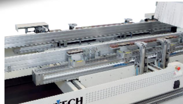
Piano di lavoro dotato di speciali cinghie per il trasporto di elementi assemblati e due file di ventose dedicate, gestite da CN che si posizionano in funzione delle dimensioni del pezzo.
