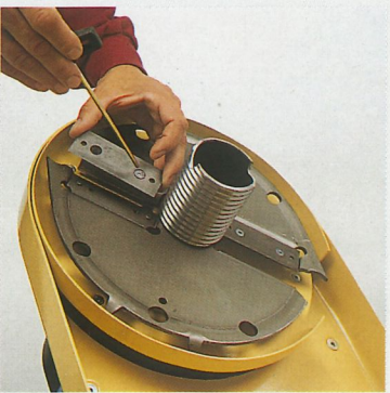
Die Häckselmesser aus Spezialstahl bleiben lange scharf. Es sind Wendemesser, die im Bedarfsfall im Handumdrehen gewendet oder ausgetauscht werden können. Sie sind auch nachschleifbar.
