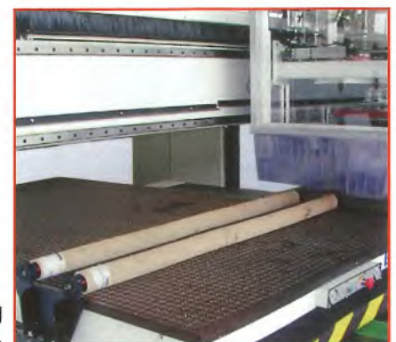
Automatische Abladung für Nesting-Tafeln
