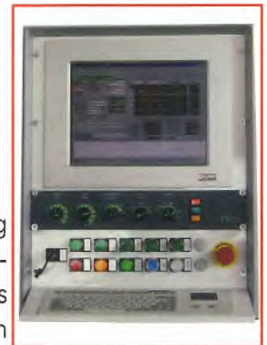
Numerische Steuerung Osai Net PC mit integriertem Computer, Windows Betriebssystem
