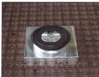
Beispiel eines außermittigen Aluminiumsaugnapfs
