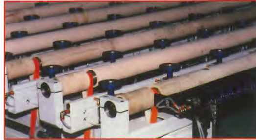
Zur durchgehenden Bearbeitung großer Tafeln mit motorisierten Rollen und versenkbaren Saugnapfen ausgestatteter Arbeitstisch
