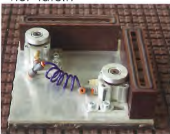
Spezialsaugknöpfe für kehlige Werkstücke, die mit versenkbaren Bezugskolben ausgestattet sind
