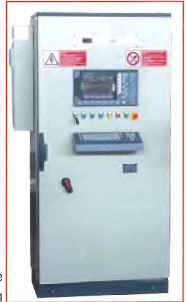
Am Schaltschrank angebrachte numerische Steuerung
