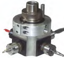
Aggregat mit 4 waagrecht Ausgängen
