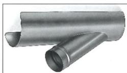
**Anniestutzen** sind oft die einfachste Art, an vorhandene Rohrleitungen ein abzweigendes Rohr anzuschließen. Es ist dringend zu beachten, daß die Rohrquerschnitte aufeinander abgestimmt sind und in allen Rohrleitungen ausreichende Luftgeschwindigkeiten bleiben. Der Einbau von Absperrschiebern hilft hier weiter.
