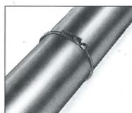
**Rohre** von „Schuko“ sind aus sendzimirverzinktem Stahlblech, mit einer Baulänge von ca. 1000 mm. Sie haben, wie alle Bauteile von „Schuko“, an beiden Enden eine Bördelung zur einfachen Weiterverbindung mit anderen Teilen mittels Rohrschellen.
