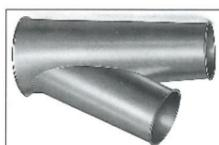
**Abzweige** werden eingebaut, wenn die Saugleitung verzweigt, also an zwei oder mehrere Absaugstellen, geführt werden soll. Ein Abzweig besteht aus dem Rumpfteil und den darin eingearbeiteten Abgängen. Die Abgänge haben 22,5 Grad zur Mittelachse des Rumpfes.
