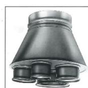
**Saugglocken** sind eine Art Abzweig, wo auf engstem Raum ein Hauptrohr in mehreren Maschinenanschlüssen endet. Die Anschlüsse können von unterschiedlichstem Durchmesser sein. Auch hier ist darauf zu achten, daß die Summe der Fläche der abgehenden
