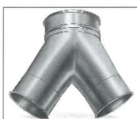
**Hosenstücke** werden dann eingesetzt, wenn ein Hauptrohr in zwei gleich großen Anschlüssen endet. Jeder Anschluß zweigt unter 22,5 Grad oder unter 30 Grad zur Mittelachse des Hauptrohres ab.
