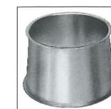
**Übergangsstücke** helfen, den größeren Durchmesser auf einen kleineren zu reduzieren. Es ist sinnvoll, den großen Durchmesser möglichst lange beizubehalten. Je größer der Durchmesser, um so geringer ist der Reibungswiderstand und somit der Saugverlust.
