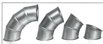
**Rohrsegmente** und **Rohrbogen** mit auf den Durchmesser abgestimmten Radien ermöglichen die platzsparende Verlegung von Rohrleitungen und Maschinenanschlüssen. Alle Bögen sind in Segmentbauweise gefertigt und aus sendzimirverzinktem Stahlblech.
