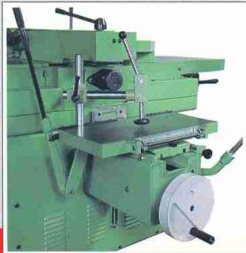
Questo sistema è estremamente preciso e scorrevole anche in condizioni di lavoro sfavorevoli. Le guide sono autopulenti e non necessitano di nessun tipo di manutenzione.
