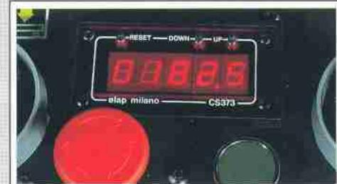
La FS 51, a richiesta, può essere equipaggiata con un visualizzatore numerico elettronico o meccanico per l'altezza del piano a spessore.
