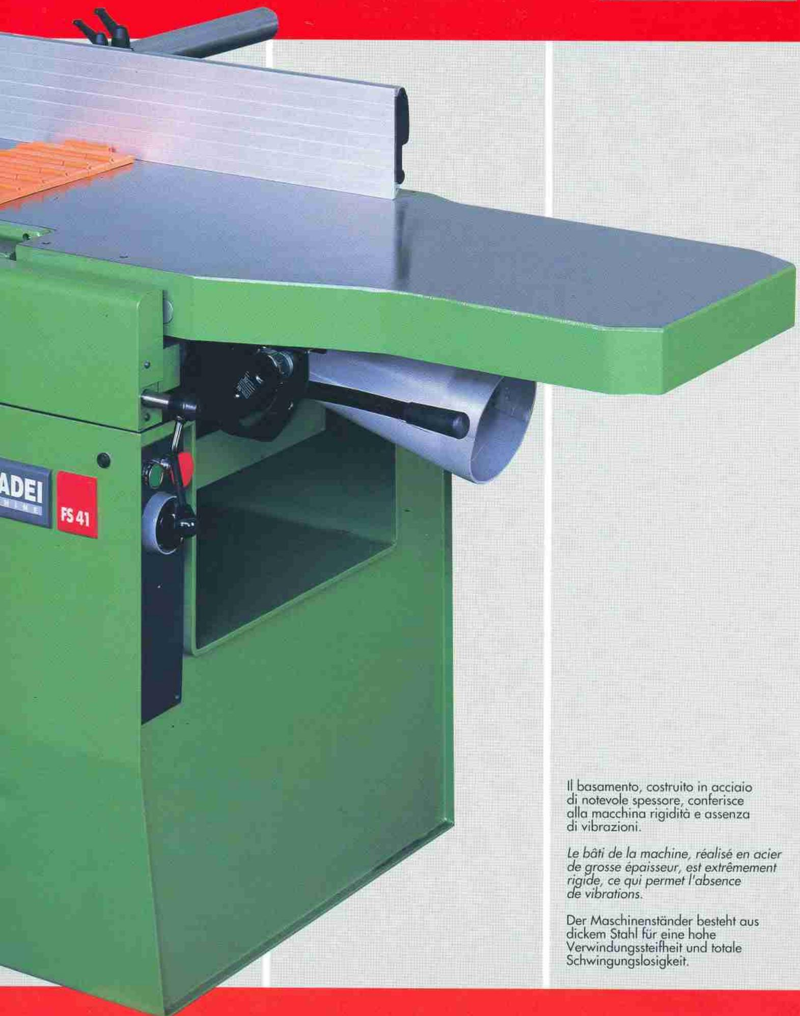
Il basamento, costruito in acciaio di notevole spessore, conferisce alla macchina rigidità e assenza di vibrazioni.
