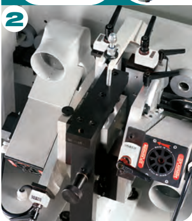
GRUPPO SPIGOLATORE con 2 motori HF inclinabili 0° - 35° e regolazione micrometrica con lettore digitale numerico - N° 2 fresse con raggio 2 mm.
