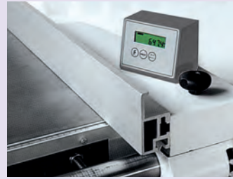
Option Lettore elettronico posizione della guida parallela Lecteur électronique position du guide sur la table Lector electrónico posicionamiento tope paralelo
