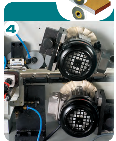
GRUPPO SPAZZOLATORE a 2 motori kw 0,37 con dischi in stoffa diam. 150 mm.
