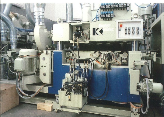
Hochleistungs-Bandhobelmaschine mit Verschiebungsrahmen und oszillierenden horizontalen Messerwellen
