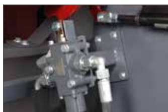
Das Sicherheitsventil verhindert bei geöffneter Schutzhaube ein unbeabsichtigtes Auslösen des Spaltvorganges.
