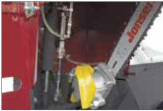
Die Kette vom Sägeaggregat wird erst nach der Abwärtsbewegung in Betrieb gesetzt. Das sorgt für Sicherheit, unnötiger Ketten- und Schienenverschleiß ist daher ausgeschlossen.
