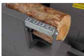
Einstellbare Scheitlänge (250 – 500 mm)
