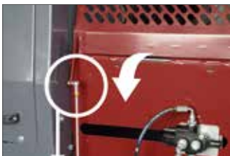
Beim Öffnen der Schutzhaube wird der Hydraulikkreislauf für alle Funktionen unterbrochen. Somit ist die Sicherheit nach den EU-Richtlinien gewährleistet.
