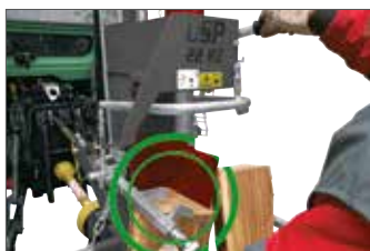
Während links mit dem beweglichen Bedienhebel der Holzstamm mittig zum Spaltnesser ausgerichtet wird, schaltet man rechts den Zylindervorschub über das Hydro-Ventil. Die Doppelfunktion des linken Bedienhebels hat den Effekt einer dritten Hand.
