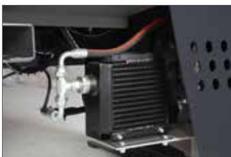
Die KSA 385 ist serienmäßig mit Ölkühler ausgestattet und gewährleistet den Dauerbetrieb.
