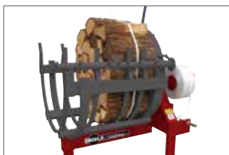
1. Bündeln (besonders geeignet für Bündel in Europallettengröße, die von Holzhändlern bevorzugt wird.)
