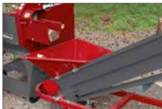
Da die sonst übliche Wipp-Bewegung entfällt, ist garantiert, dass das abgesägte Holz direkt und gerade in den Trichter des nebenstehenden Transportbandes fällt.
