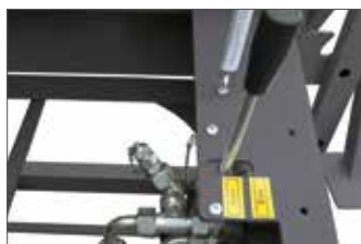
Durch ein bedienbares Hydraulikventil lässt sich das Sägeblatt in unmittelbarer Reichweite des Bedieners zu- und abschalten.
