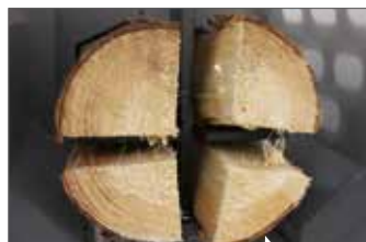
4-er Spaltkreuz: Gleichmäöig groöe Scheite sind das Resultat.
