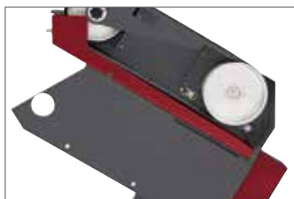
Durch den unter dem Schleifband befindlichen Späneleitkanal werden Staub und Schleifspäne in den am Fußteil angebrachten Spänekasten geschleudert (Patent-Nr. 0399155).
