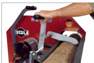
Die professionelle Zweihandbedienung: Eine Hand sichert über die Holzhaltekralle das Schnittgut.
