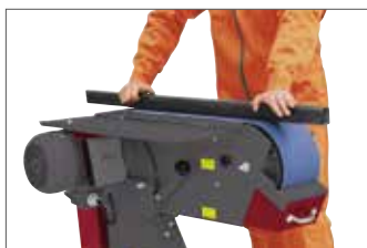
Die durchgehende Planschleiffläche erlaubt das Bearbeiten langer Werkstücke.
