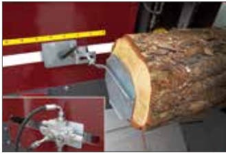
Das Zuführband wird über ein Hydraulikventil in Stopp-Stellung geschaltet. Durch Verschieben des Ventils kann vor Arbeitsbeginn die gewünschte Scheitlänge eingestellt werden.
