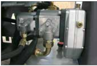
Die hohe Vorlaufgeschwindigkeit des Spaltzylinders resultiert aus der großdimensionierten Hydraulikpumpe Größe III. Die darauf folgende Tandempumpe wird für die Nebenfunktionen, Spaltkreuz auf/ab und Hebearm verwendet.
