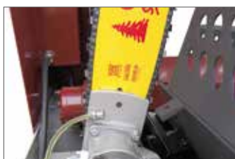
Die Kette vom Sägeaggregat wird erst nach der Abwärtsbewegung in Betrieb gesetzt. Das sorgt für Sicherheit, unnötiger Kettenölverbrauch und Schienenverschleiß sind daher ausgeschlossen.
