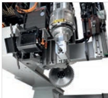
Elektrospindel mit 19,2 kW.
