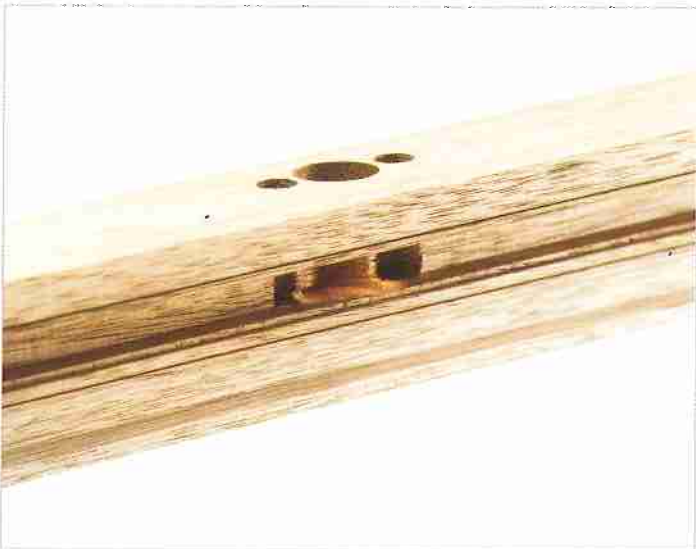
Komplette Bearbeitung von Fräsungen oder Bohrungen für Beschläge und Zubehör in einem Arbeitsgang.
