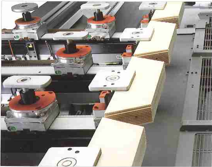
Bearbeitung von Bögenelementen, ausgehend von einem einzigen Balken.
