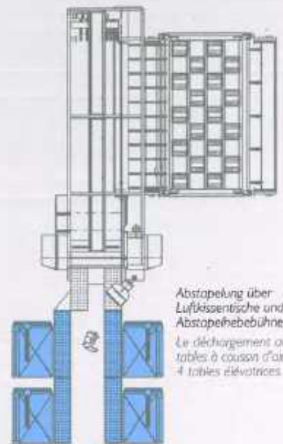
Ab stapelung über Luftkissentische und 2 Ab stapelhebebühnen. Le déchargement avec tables à coussin d'air et 2 tables élévatrices.
