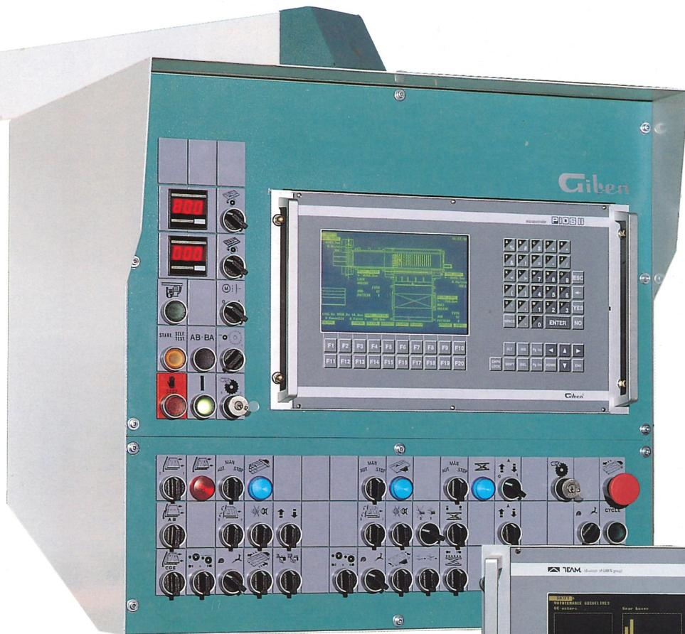
**Accessibilité maximale et ergonomie des commandes. Le pupitre de contrôle et le programmeur électronique sont montés sur un panneau positionné à côté du guide d'équerre du cadre, pivotable sur 180°.**
