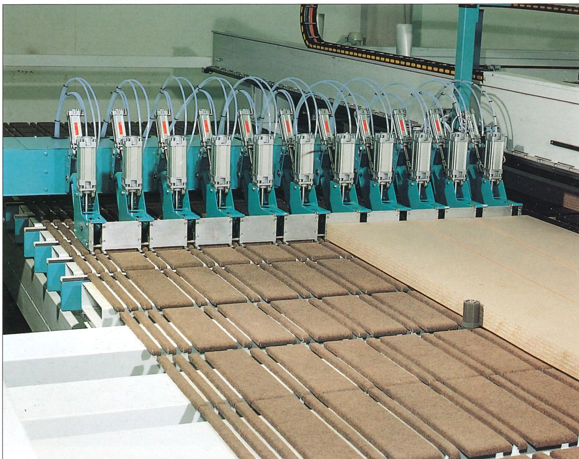
**Le pousseur transversal transfère automatiquement le paquet de bandes sur la ligne de coupe transversale.**
