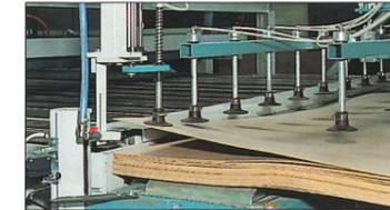
Ventouse auxiliaire afin de faciliter le décollement des panneaux, avant la phase de préhension par le chargeur à ventouses.
