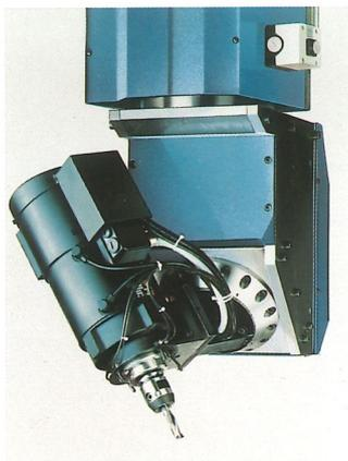
Das schwere Robotaggregate leistet 7,5 kW bei 36.000 1/min oder 8 kW bei 40.000 1/min und ist mit Werkzeugwechsler-System HSK 32 ausgestattet. 6 Plätze stehen im mitfahrenden Magazin zur Verfügung. Ureol- und Aluminiumformen werden mit dieser Aggregateausstattung problemlos bearbeitet.
