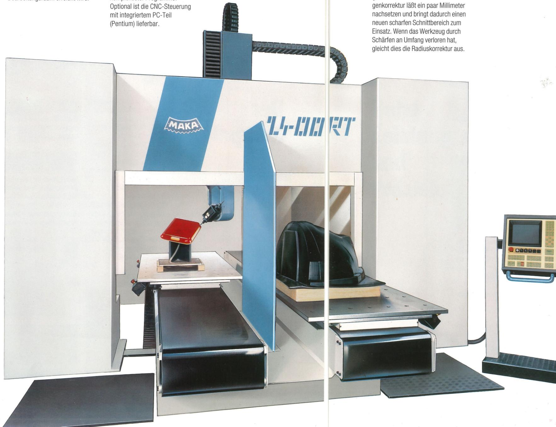
**Das Maschinenkonzept entspricht dem einer Werkzeugmaschine. Das feststehende Portal und der bewegliche Maschinentisch erlauben hohe Arbeitsvorschübe und Präzision bei der Bearbeitung. Die 5-Achsen-Technik bringt die Beweglichkeit eines Roboters, ohne auf Steifigkeit und Wiederholgenauigkeit zu verzichten.**
