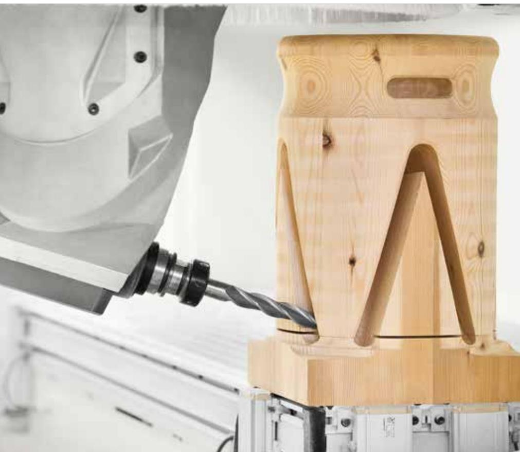
Es ist möglich, **Werkstücke mit 500 mm Arbeitshöhe** auf der Oberseite sowie seitlich, dank der hohen, vertikalen Z- Achse zu bearbeiten.
