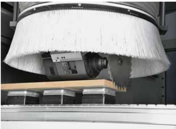
Beim 5-Achs-Fräsen ist die **äußere Haube** im Einsatz, die entsprechende Abmessungen hat, um die Werkzeugbewegungen zu umschließen.
