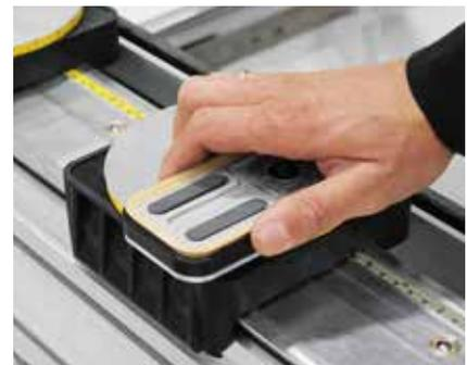
Dank der Schnellankopplung und des **schlauchlosen Systems** zur Vakuumübertragung kann der Arbeitstisch, je nach Geometrie des zu bearbeitenden Werkstücks, frei konfiguriert werden.
