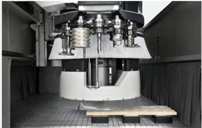
Beim Fräsen mit Vertikalwerkzeug ist die **innere Haube** im Einsatz, die für diese Art von Operationen dank ihrer geringen Abmessungen effizienter ist.
