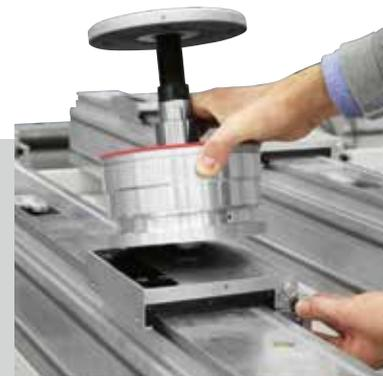
Praktischer und schneller Wechsel per Knopfdruck von Sauger auf Spannzylinder und umgekehrt durch das von SCM entwickelte Schnellspannsystem.
