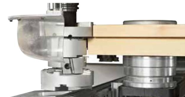
Mithilfe des Systems **TTS (Total Torque System)**, exklusiv bei SCM-Produkten, wird die Rundachse mechanisch blockiert im Fall von Bearbeitungen mit vertikalem Werkzeug, wodurch eine größere Steifheit des Systems erzielt wird.
