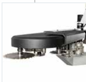
Am beweglichen Portal befestigtes Kettenmagazin mit 32 Positionen, entwickelt für die Verwaltung von sehr schweren und großen Werkzeugen.
