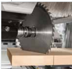
Vorderfräsaggregat mit 5-Achs-Elektrospindel.
