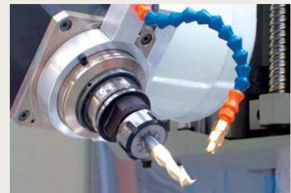
**Testa con lubrorefrigerazione gestita automaticamente**
