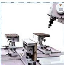
**Combi:** banchi per il corretto allineamento dei pezzi che vengono bloccati con pressori a comando azionati da cilindri pneumatici. Possono essere utilizzati in posizione orizzontale o verticale.
