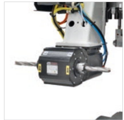
Horizontaler Motor mit 1 oder 2 Ausgängen für Schlüsselaussparungen und horizontale Bearbeitungen.
