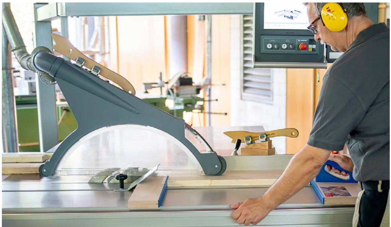
Abb. 8 Absaugung an der Entstehungsstelle
