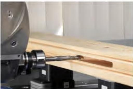
Cabezal para trabajos horizontales
