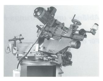
Maschine über **Handrad** (Schneckengetriebe) geneigt und mit **hydraulischer Vorschubbremse** (verhindert das Hineinziehen des Sägeblattes in das Schnittgut, bei Alubearbeitung unbedingt erforderlich).
