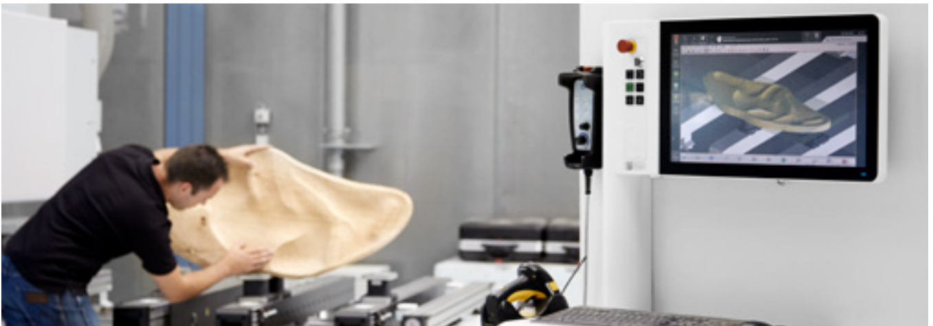
3D-Scannen und Programmieren eines Kundenbauteils
