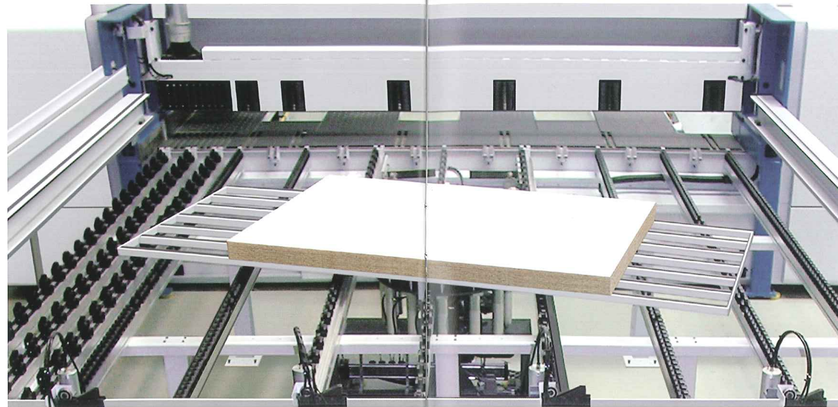
CNC-Messeinrichtung für Plattenpakete in Grundstellung. CNC measuring device for books of panels in basic position.
