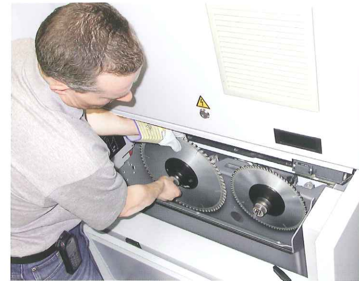
Freie Zugänglichkeit für Wartung und Sägeblattwechsel. Schnellspannvorrichtung „Power Lock“.
