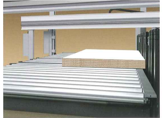
Angetriebene Rollenbahn auf dem Hubtisch. Powered roller conveyor on lift table.
