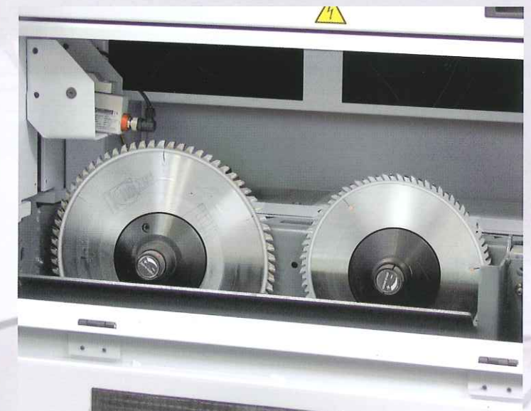
Variable Sägeblatt-Drehzahl – beste Schnittqualität für jedes Material. Variable rpm for main saw – perfect cutting quality for all kinds of panels.
