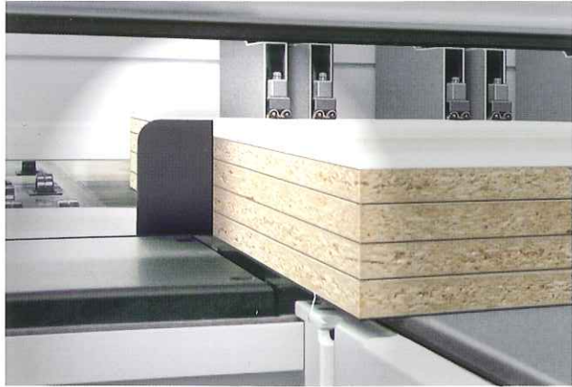
Zentrale Winkelandrückvorrichtung. Einstellbare Kraft und Präzision genau auf den Punkt.
