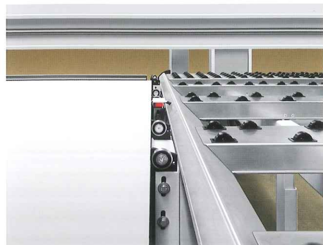
Paketübergabe vom Hubtisch zum Maschinentisch. Transfer of book from lift table towards the machine table.
