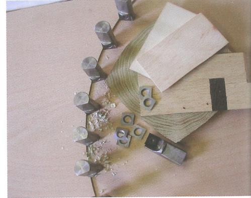
Durch die besondere Art der Bearbeitung (das Werkzeug dreht sich in horizontaler Ebene von links nach rechts und arbeitet wie ein Fräser) ist es möglich sehr kurze Werkstücke zu bearbeiten, ohne daß Wellenschlag an den Enden vorkommt. Das Werkzeug ist mit Wendepättchen ausgerüstet. Nach der Abnützung auf einer Seite werden die Pättchen umgedreht. Ein Pättchen kann bis zu 4 mal gewendet werden, erst dann muß es ausgewechselt werden.
