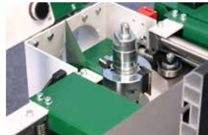
Die Funktion mit einem seitlichen Fräskopf kombiniert mit einem Abricht-Dickenhobel, eröffnet Dir viele Möglichkeiten. Zum Beispiel seitlichen Profilierungen wie Nut & Feder oder Verleimprofile.
