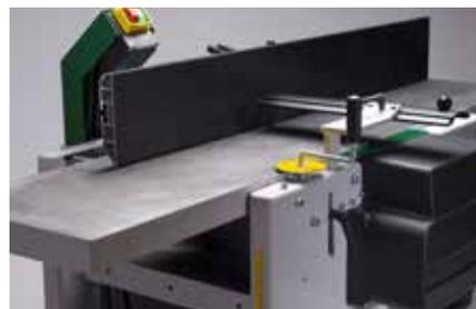
Kein Umbau! Abrichten auf den oberen Tisch, Planhobeln direkt im Anschluss auf dem unteren.
