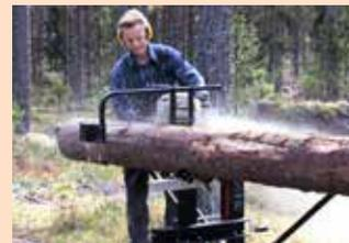
Der erste Sägeschnitt. Der Stamm wird festgeklemmt und die Kette sägt leicht durch den Stamm mit sehr schönem Schnittergebnis.
