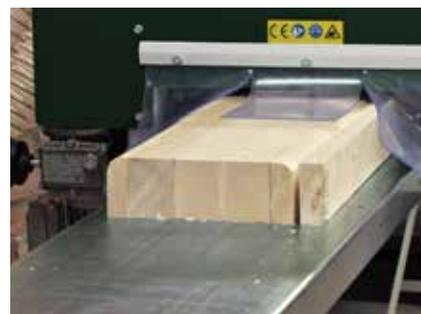
Das Kreissägeblatt gibt den kräftigen Balken exakte Maße und gleichzeitig werden 2 Kanten abgerundet. Sägt und profiliert in einem Arbeitsgang.
