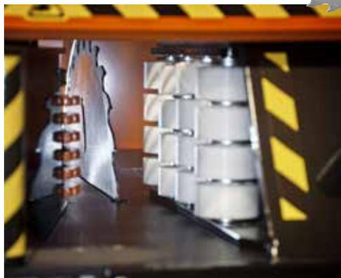
Die Vorschubwalze transportiert das Holz durch die Maschine und presst das Werkstück gegen einen Anschlag mit Rollen.
