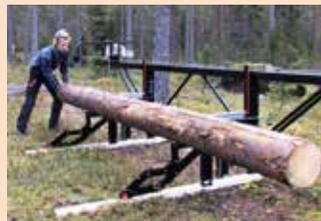
Mit der Stammterasse bringst Du selbst die Stämme vom Boden auf das Sägewerk. Dort kannst Du in bequemer Arbeitshöhe weiter arbeiten.
