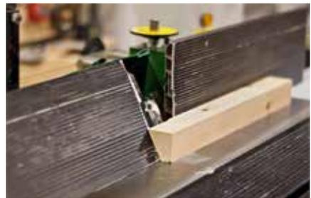
Einzigartiges Merkmal der MF30 – Beide Anschläge sind im Winkel und der Tiefe mit Feineinstellung verstellbar. Für perfekten Halt während des Fräsvorgangs.
