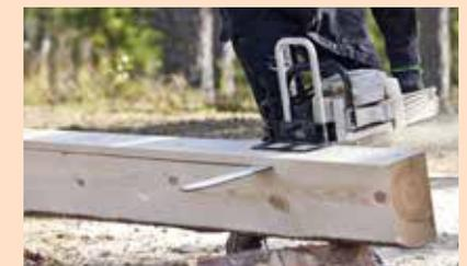
Danach wird der Holm abgebaut und es wird mit dem Timmerjigg allein weitergearbeitet. Dann ist auch die Stärkeeinstellung stufenlos in Millimeter einstellbar.
