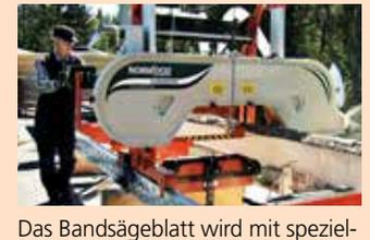
Das Bandsägeblatt wird mit speziellen Keramikführungen sehr exakt durch den Stamm geführt. Eine automatische Wasserkühlung schont die Sägebänder und die Präzision erhöht sich nochmals
