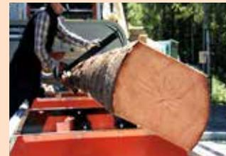
Sichere Stammhantierung, in ergonomischer Höhe, mit Wendehaken, schont Rücken und Knie.
