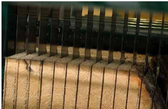
Die Gattertechnik ergibt ein unschlagbares maßgetreues Ergebnis. Die speziell angefertigten Sägeblätter mit Zähnen aus Hartmetall schaffen bis zu zwei Tage Produktion bevor ein Nachschliff erforderlich ist.
