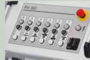
Vom Steuerpult werden alle Wellen und auch das Vorschubaggregat gesteuert.
