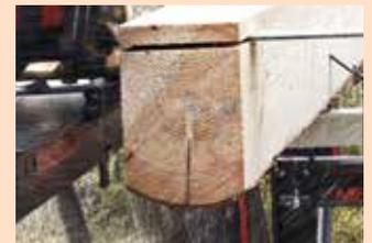
Den Sägeschlitten zurücknehmen, den Stamm mit den eingebauten Seilwinden anheben und Bretter aus dem Stamm schneiden.
