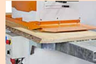
Der Seitenschutz wird vom Brett angehoben wenn breite Werkstücke besäumt werden.
