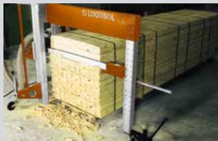
Einstellen und auf Start drücken. Die lange Sägeschiene kappst sicher, einfach, exakt und schnell.
