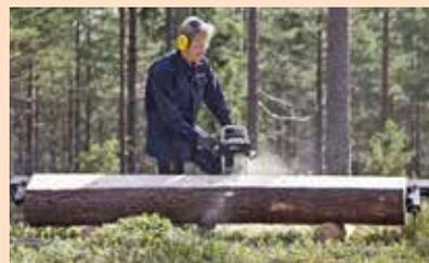
Es ist einfacher, ein perfektes Ergebnis zu erzielen, wenn man von der Mitte ausgeht. Die Rechte und die Linke Holmhalterungen werden immer auf die gleiche Höhe montiert.
