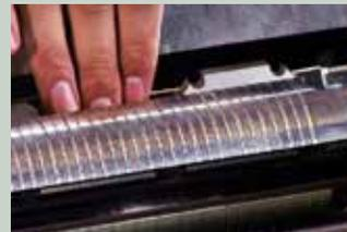
Profilmesser in der Messerwelle für das gewünschte Profil montieren.
