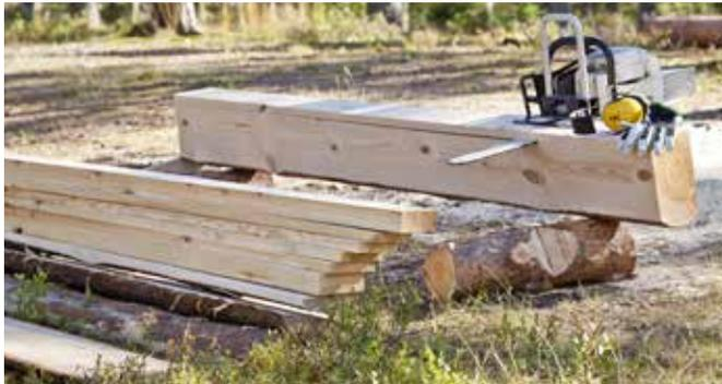
Mit dem Timmerjigg sägst Du den Block in fertige Balken und Bretter auf.
