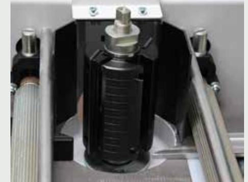
Flexiblen Fräskopf für hohe Werkstücke!
