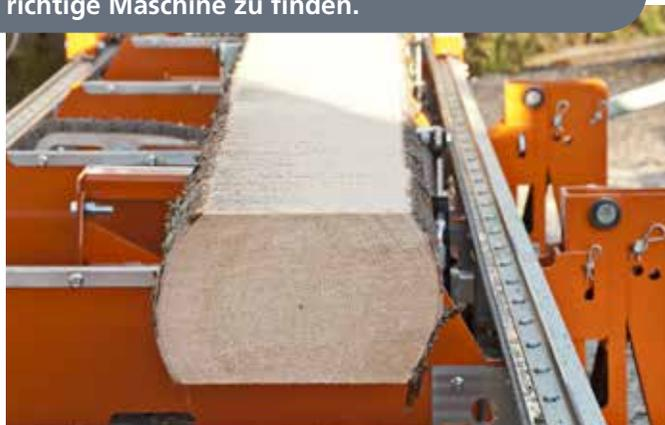
Die Stämme werden auf zwei Seiten vorgesägt, dann werden sie durch die Gattersäge gelassen. Eine einzigartige sehr schnelle Sägetechnik mit exakten Ergebnissen.
