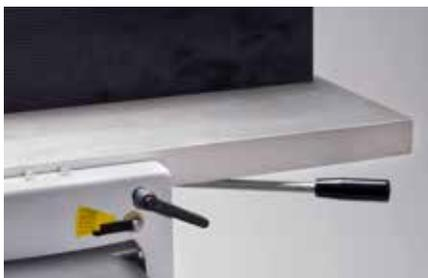
Der Abrichttisch bzw. die Abnahme wird mit einem Hebel eingestellt. Spanabnahme 0-10 mm.
