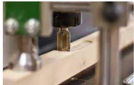
Aussparung für Scharniere, nur ein Beispiel für die Bearbeitung in Oberfräserposition.
