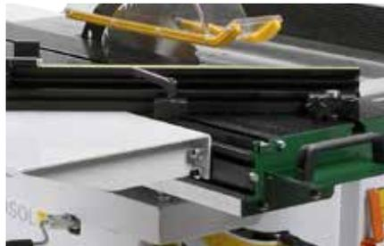
Der Schiebeschlitten läuft auf gehärteten 18 mm Stahlkugeln. Damit ist er auch unter schwerer Belastung leichtgängig.
