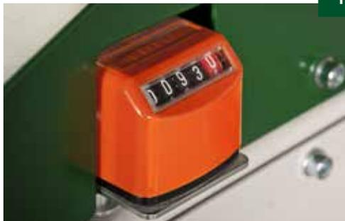
Mechanische Zählwerke für Horizontalwelle und die seitlichen Spindeln.
