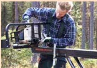
Die Motorsäge wird einfach auf den Schlitten, der sehr leicht und exakt auf dem Führungsholm gleitet, montiert.
