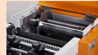
Das Kreissägeblatt trennt und gleichzeitig hobelt und/oder profiliert die Horizontalmesserwelle.
