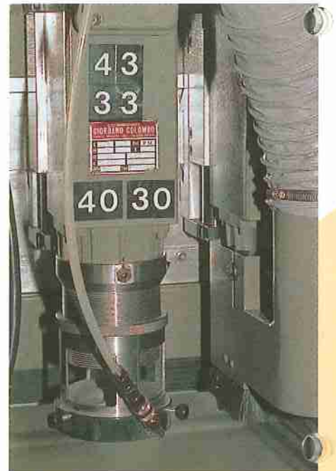
▲ Schwimmend gelagerter Kopf, um der Werkstückoberfläche genau folgen zu können.
