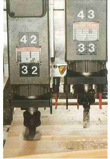
▲ Vertikalfräseinheit mit MK2-Anschluß.
