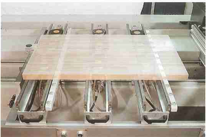
▲ Positionierhilfe für schwere Werkstücke
