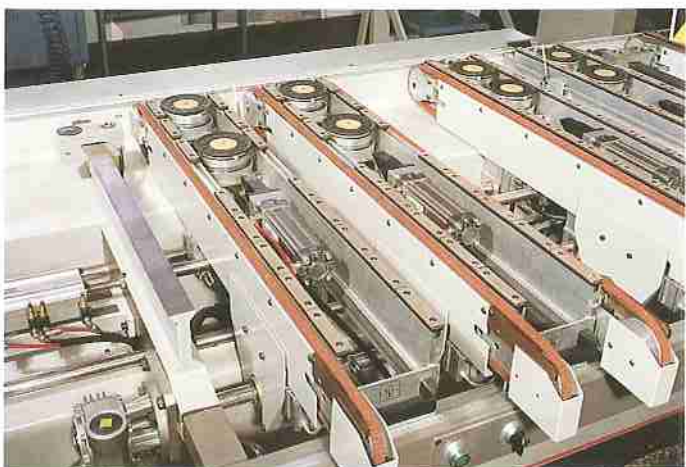
▲ Arbeitstisch mit automatischer Werkstückbe- entladevorrichtung und Sektoren für durchgehende Fräsarbeiten
