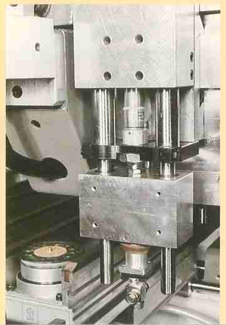
▲ Schwimmend gelagerter Kopf, um der Werkstückoberfläche genau folgen zu können.
