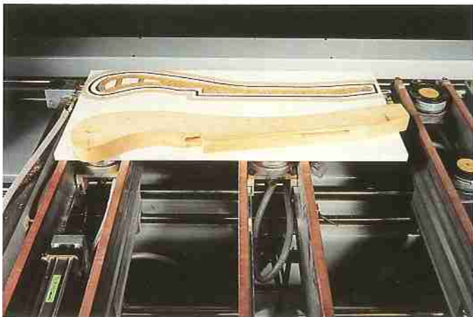
▲ Gegenschablonen ermöglichen die Fertigung von Sonderteilen
