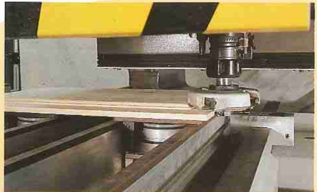
▼ Bearbeiten eines Fensterflügels
