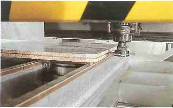
▲ Vorbereiten der Nut für PVC-Umleimer
