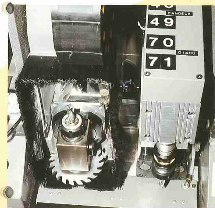
▲ 10 HP Elektrospindel und Horizontalfräser.
