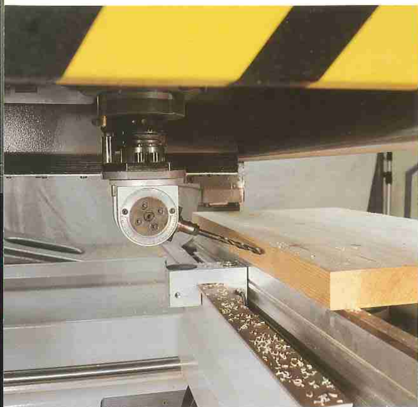
Horizontal und vertikal verstellbarer Winckelgetriebe mit Aufnahme für Bohrer und Nutsäge.
