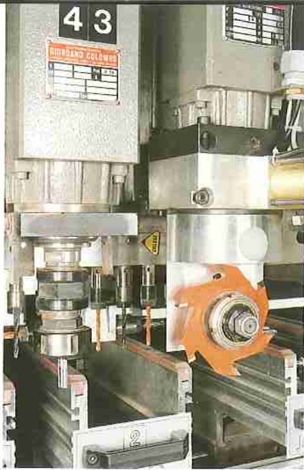
▲ Nutenfräser mit automatischer Drehung.
