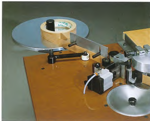
Particolari gruppi cesoia ed incollaggio con doppio rullo. Cutting groups and double roll glueing device. Guillotine und leimen mit doppelwalze. Particulaire groupe de coupe et bac à colle avec 2 rouleaux. Detalle de la cuchilla cotodara y del grupo encolador con doble rolo. Particulare do grupo corte e dobre rolho de encolagem.
