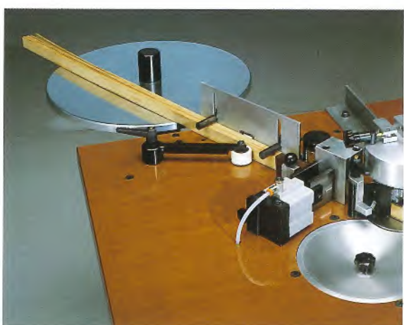
Bordatura listelli. Solid wood strips edgending. Gerade kanten aus massivholz. Placage d'alaises. Canteado de molduras. Orlagem de madeiras.
