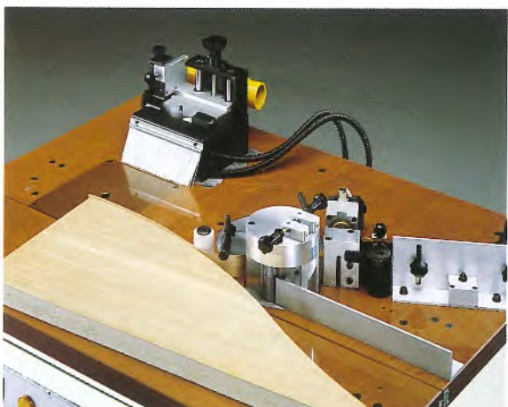
Bordatura pezzi curvi. Round pieces edgending. Krummstukkanten. Placage des pices rondes. canteado de paneles redondos. Orlagem dos paineis arredondados.
