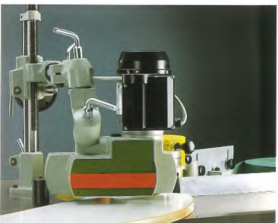
Bordatura pezzi curvi con trascinatore automatico. Round pieces edgending with automatic feeding unit. Krummstukkanten mit automatischer transport. Placage des pices rondes avec entreinment automatique. canteado de paneles redondos con avanze automatico. Orlagem dos paineis arredondados com avanço automatico.
