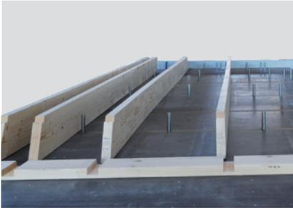
**Le système de serrage à commande numérique** permet le bridage et le positionnement automatique des barres.
