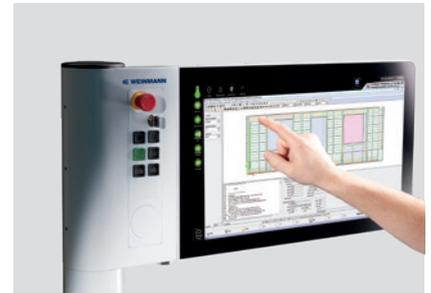
**wupWorks 3** в полностью автоматическом режиме преобразует созданные CAD данные и передает их в систему управления станка.
