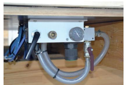
Комплект пневматического оборудования для централизованного снабжения сжатым воздухом и управления крепежными балками C-PowerTec
