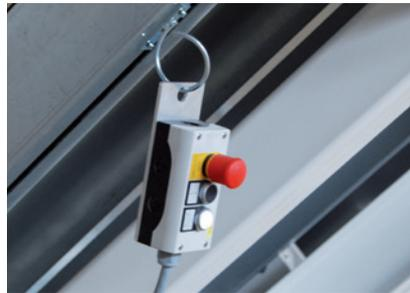
**Подвесной пульт управления (размещается на столе произвольно)**
