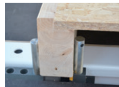
Chwytaki do elementów dachów i stropów ułatwiają układanie i mocowanie krokwi i belek.
