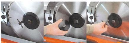
*Zahnradschlüssel ansetzen und zum Lösen der Mutter drehen (Foto links), Fixierscheibe entfernen und Sägeblatt wechseln (Foto Mitte). Dann einfach die Fixierscheibe wieder aufsetzen und fest anziehen.*
