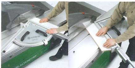
*Die Längenausgleichsskala befindet sich auf beiden Seiten des DUPLEX und DUPLEX D. Somit lässt sich der Maßausgleich problemlos beidseitig einstellen.*
