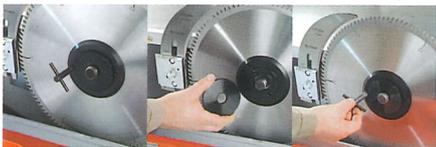
*Zahnrad Schlüssel ansetzen und zum Lösen der Mutter drehen (Foto li), Fixierscheibe entfernen und Sägeblatt wechseln (Foto mitte). Dann einfach die Fixierscheibe wieder aufsetzen und fest anziehen.*
