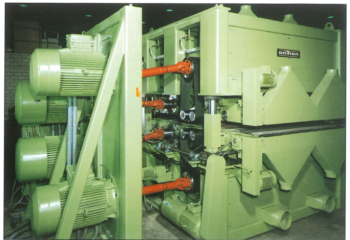
Motorträger für Antriebsmotoren der Schleifaggregate Motor supports to carry the sanding unit's driving motor
