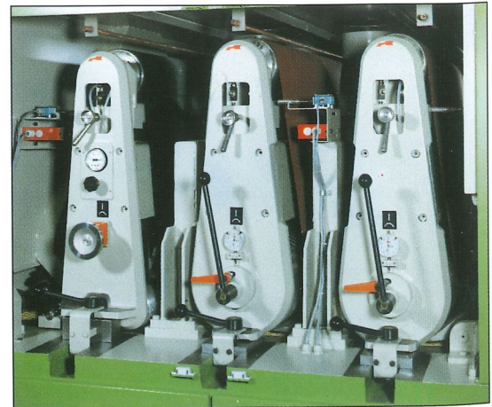
Saphir mit 3 Aggregaten, Walze und Schleifschuh Saphir with 3 units, roll and sanding pad
