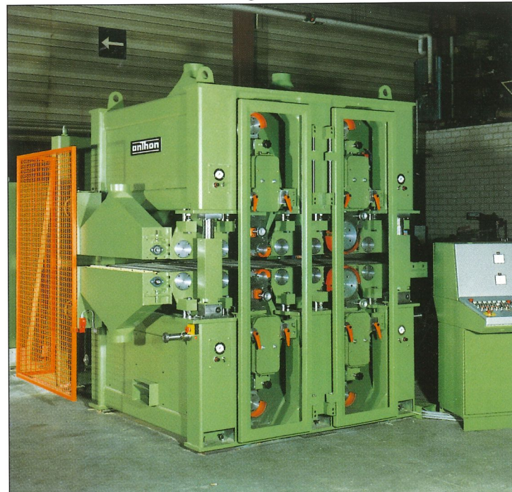
Doppelseitige Kalibriermaschine CD mit 2 Walzen/2 Schuhen Double-sided CD calibrating machine with 2 rolls/2 pads
