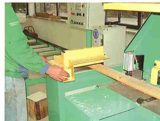
Kappsägen manuell oder automatisch für den exakten Längen- Zuschnitt. Manual or automatic cutting saws for the exact trim length.
