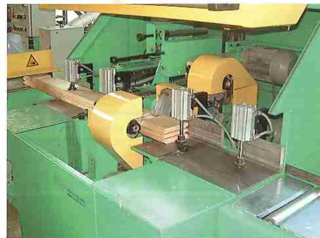
Vierfach Fräsaggregat zu Erzeugen der Chalet-Eckverbindungen in einer Aufspannung. Four mold milling unit for manufacturing chalets- corner joint in one fixing-position.
