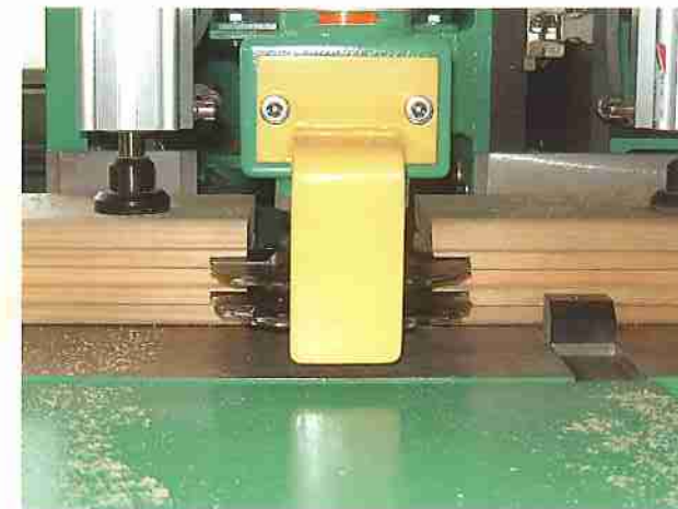
Stirnutaggregat zum Verlängern der Blockbohlen. Groove unit to lengthen the logs.
