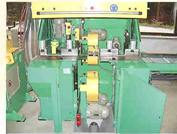
Die übersichtlich und kompakt angeordneten Bearbeitungs- aggregate sind durch die geöffnete Schutzhaube leicht zugänglich. The clearly-arranged working units are for adjustment easy to reach with the open protective hood.
