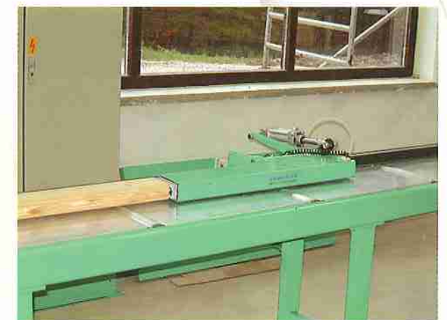
Automatischer Servo- Positionieranschlag zum komfortablen Positionieren der Werkstücke ohne Messen und Anreißen! Automatic servo- stop for convenient positioning of workpiece without measuring or marking.
