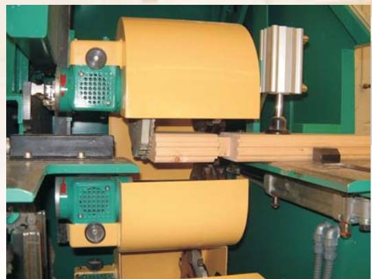
BL Twin: Längenkalibrierung in einem Arbeitshub BL Twin: calibration of length at same workstep
