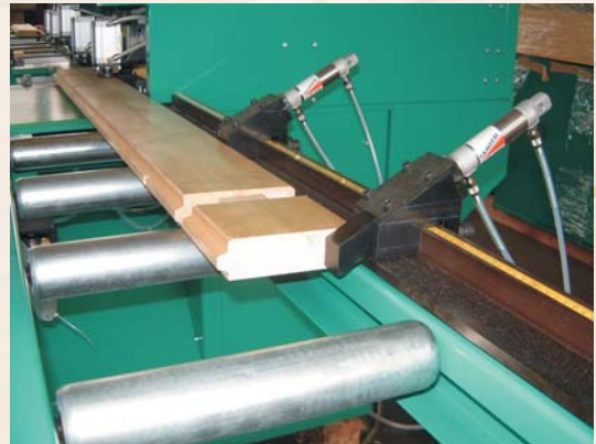
BL 100: Werkstückanschläge, manuell betätigt BL 100: Stop face for workpiece, manual operated
