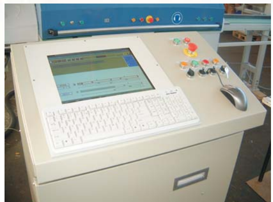
BL100A: Bedienpult mit IPC Steuerung BL100A: Operator panel with IPC control
