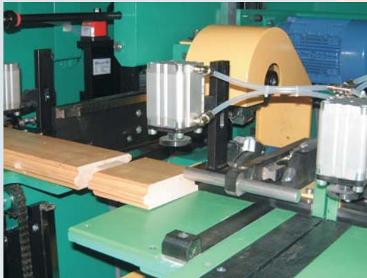
BL 100: Vorkopfanschlag manuell betätigt BL 100: Stop face for workpiece, manual operated
