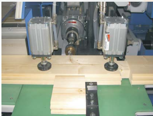
Bohrgerät mit Splitterschutz und Bohrerführung Drilling device with conter profile and driller guide
