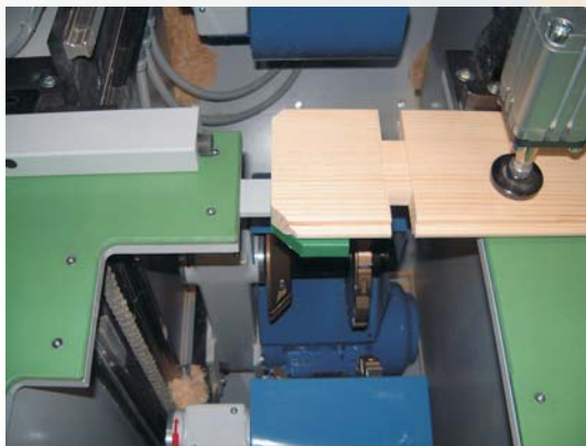
BL Twin: zusätzliche Anfasfunktion für Vorkopf BL Twin: additional chamfer function at Head
