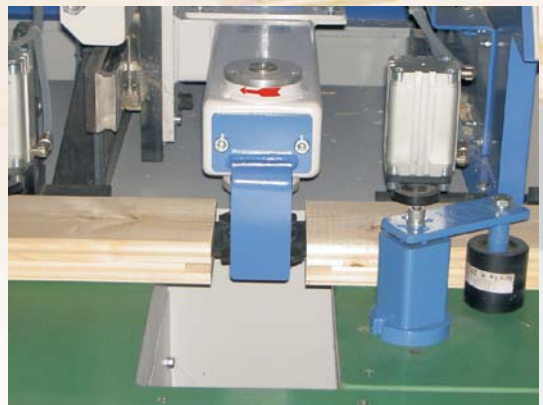
Stirnutfräse zum Nuten der Werkstückenden Groove unit for slots at the end of workpiece
