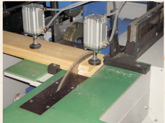
Integrierte Kappsäge in optimaler Anordnung Integrated Circular saw at ideal position
