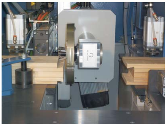
BL100A: Schwalbenschwanz Verbindungsfräse BL100A: Dovetail connection
