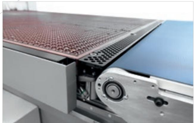
**Absaugung von unten** zwischen der Maschine und dem Abladeband.
