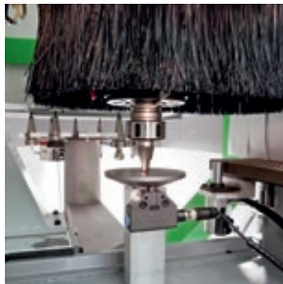
Reduzierung der Zeiten für die Maschinenbestückung, ohne Fehler von Seiten des Bedieners, dank des **Kontakt-Voreinstellgeräts**, das es ermöglicht, die Messung der Werkzeuglänge automatisch durchzuführen.
