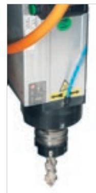
**Vertikaler fester Motor** für zusätzliche Fräsbearbeitungen (Slot, gegen Splitter, ...).
