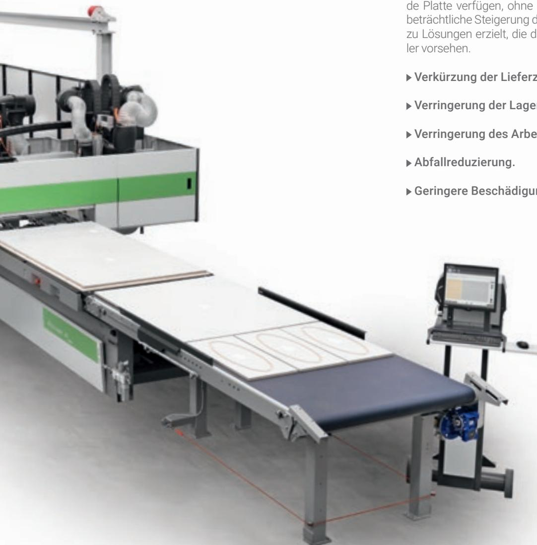
Mit **Winstore 3D K3** kann man jederzeit über die zu bearbeitende Platte verfügen, ohne häufige Stapelwechsel. So wird eine beträchtliche Steigerung der Produktivität der Zelle im Vergleich zu Lösungen erzielt, die die Stapelführung durch Gabelstapler vorsehen.
