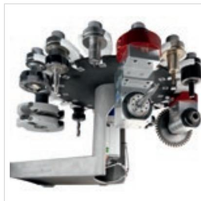
Von 8 bis 29 Werkzeuge und Aggregate in der Maschine verfügbar, ohne dass der Eingriff des Bedieners notwendig wäre, um die Bestückung beim Übergang von einer Bearbeitung zur anderen durchzuführen.
