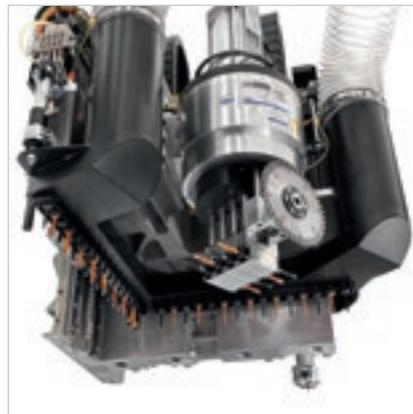
Der neue Bohrkopf **BHC32-BHC42** kann bis zu 42 unabhängige Werkzeuge für einfache und mehrfache Bohrungen auf der Oberseite des Werkstücks aufnehmen. Er wird automatisch geschmiert und ist mit einer Späne-Absaughaube ausgestattet, die automatisch aktiviert wird, wenn die Arbeitseinheit in Betrieb ist.
