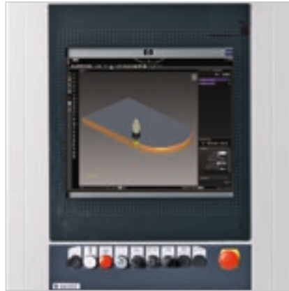
Steuerungssystem BH 660 auf PC-Basis mit Windows-Real-Time-Betriebssystem zur Steuerung der Maschine und der Benutzerschnittstelle.
