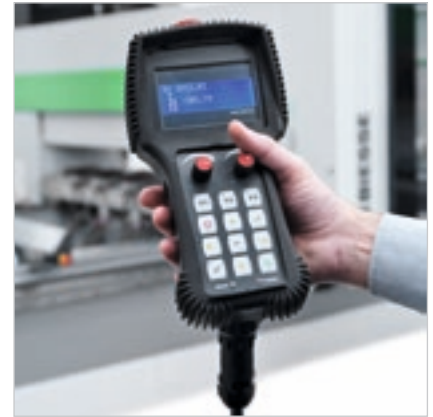
Remote-Konsole für eine direkte und sofortige Kontrolle durch den Bediener.
