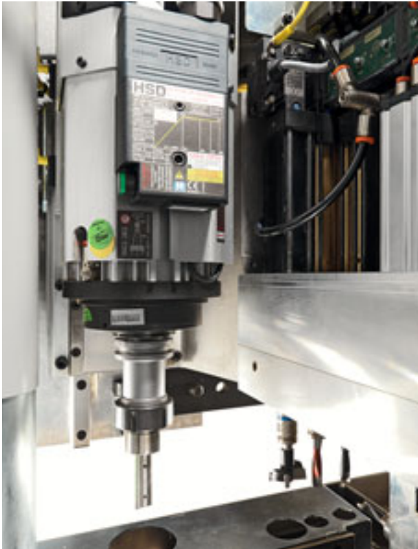
Elektrospindel mit ISO30 – Anschluß für eine schnelle und einfache Bestückung der Fräswerkzeuge.
