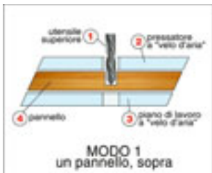
ARBEITSMODE 1 Bearbeitung von oben, ein Werkstück MODE 1 Top machining, one panel
