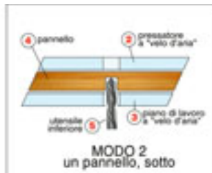
ARBEITSMODE 2 Bearbeitung von unten, ein Werkstück MODE 2 Bottom machining, one panel
