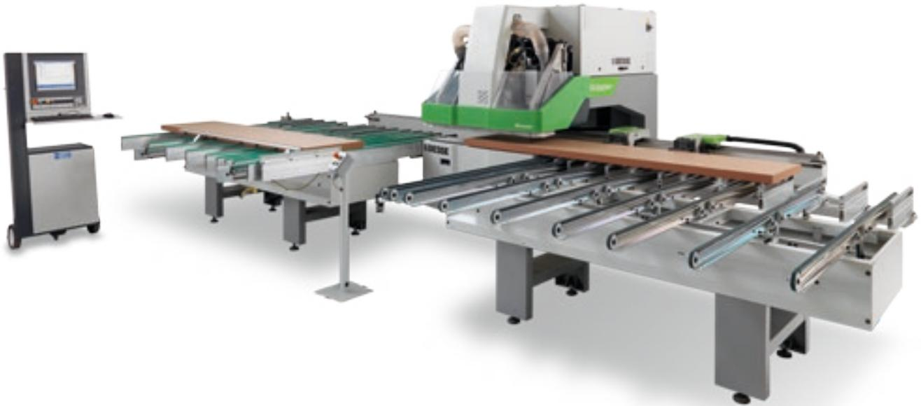
Tiempos de carga reducidos gracias al sistema automático para la colocación de los paneles que se ajustan contra los topes de manera automática.
