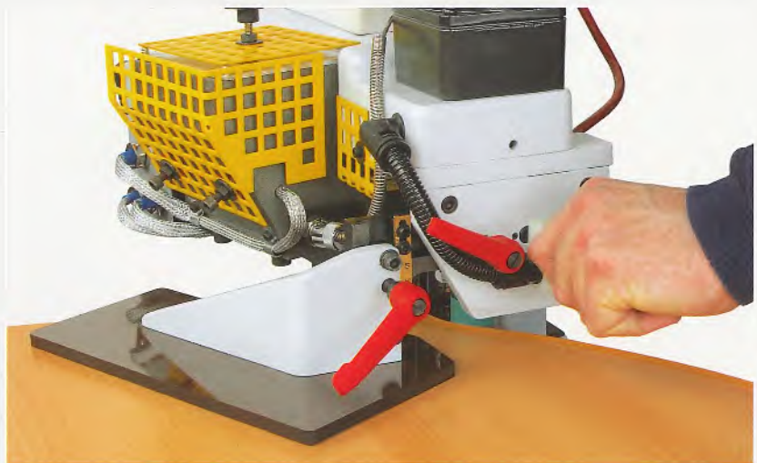
Führung des Verleimteils durch die höhenverstellbare Führungsplatte
