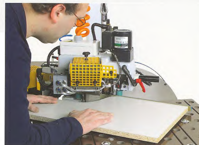
Kleine Werkstücke werden im Stationärbetrieb bearbeitet
