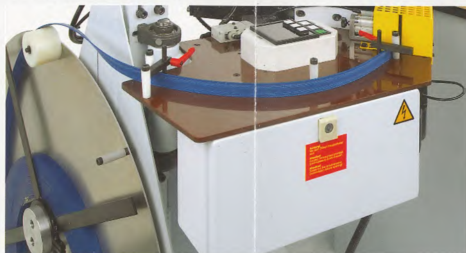
Durch den aufrecht stehenden Rollenteller reduziert sich die Stellfläche auf ein Minimum
