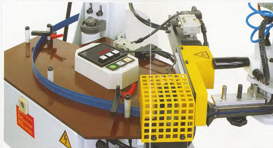
Die Kanten werden automatisch auf das eingegebene Maß abgelängt
