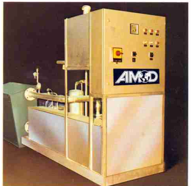
Elektro-Durchlauferhitzer mit Umwälzpumpe
