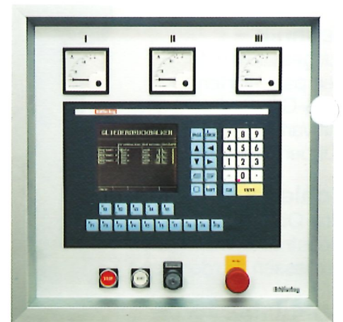
Terminal für die elektronische Maschinensteuerung mit Programmspeicher für 99 Schleifprogramme (Standard).
