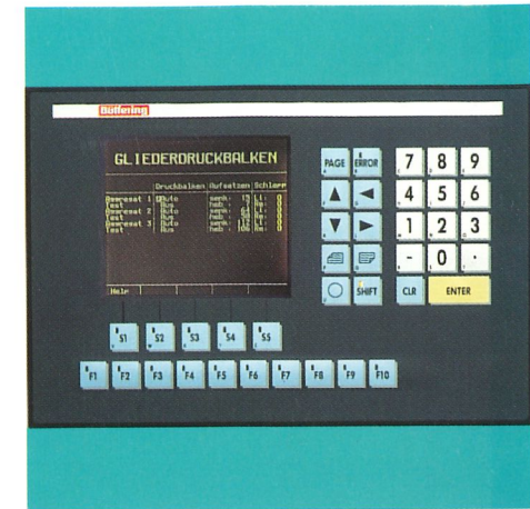
Terminal für die elektronische Maschinensteuerung
