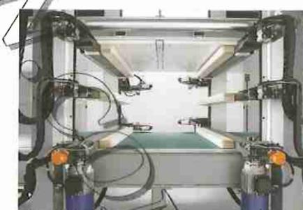
Zone de pressage d'une machine configurée avec trois couples de presseurs et groupe agrafeurs.
