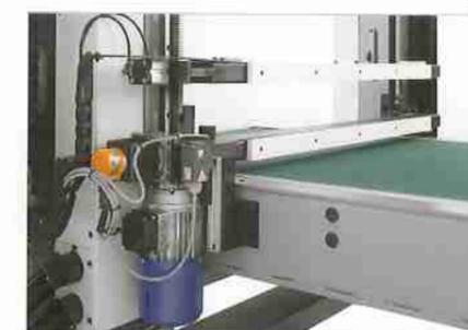
Groupe de déplacement vertical des presseurs développé pour garantir la liberté maximale de positionnement.
