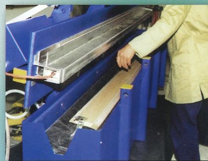
2. Das Werkstück mit dem Furnier auf das Preßkissen legen
