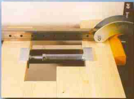
Abgesetzte Treppenstufen verleimen
