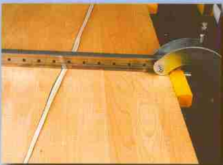
Schrägverleimen mit Zusatzpreßschlauch
