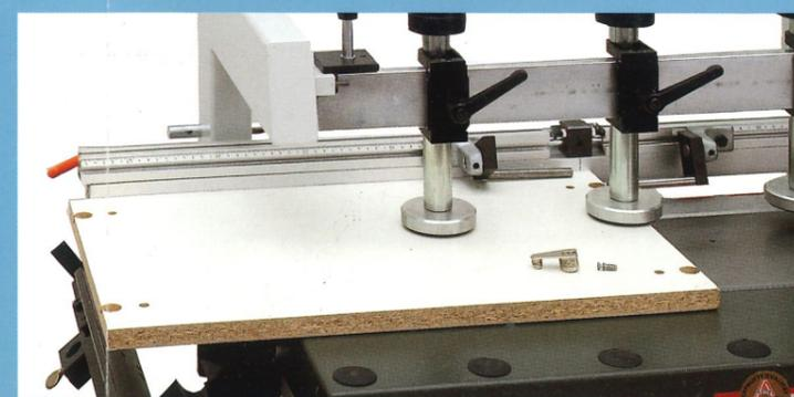
Einfaches Einbohren von Verbindungsbeschlägen im SYSTEM 32 mittels Anschläge mit Verlängerungsstift.
