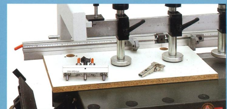
Einfaches Einbohren von Topfbändern auf Riß oder Anschlag. Anschlaglineal kann spiegelbildlich von rechts auf links umgesetzt werden für linke bzw. rechte Türen.
