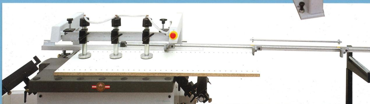
Lochreihensystem auf zwei Lochreihentiefen programmiert. Taktansläge werden mittels Einstelllehre eingestellt und müssen bei Topfband oder Verbindungsbohrungen nicht entfernt werden.
