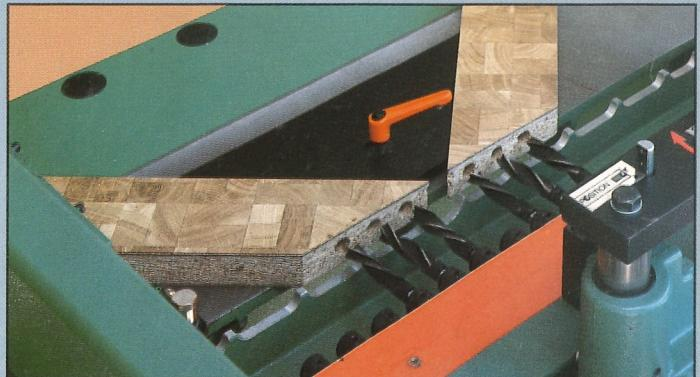
Bohren von Gehrungsrahmen mittels Gehrungsanschlag.
