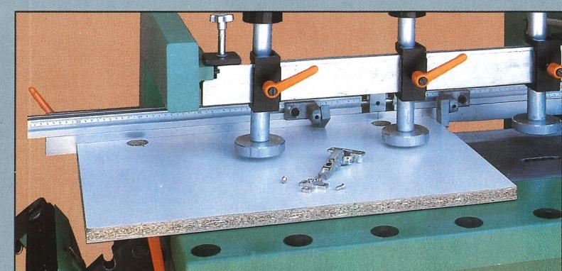
Einfaches Einbohren von Topfbändern auf Riß oder Anschlag. Anschlaglineal kann spiegelbildlich von rechts auf links umgesetzt werden für linke bzw. rechte Türen. Drilling of holes for hinges on a sign or stops, stoppingfence can be turned from right to left for precise drilling of left and right doors. Perçage simple pour charnières à cuvette sur marquage ou butée. La règle-butée peut être inversée (image de miroir) de droite à gauche pour portes droites ou gauches.
