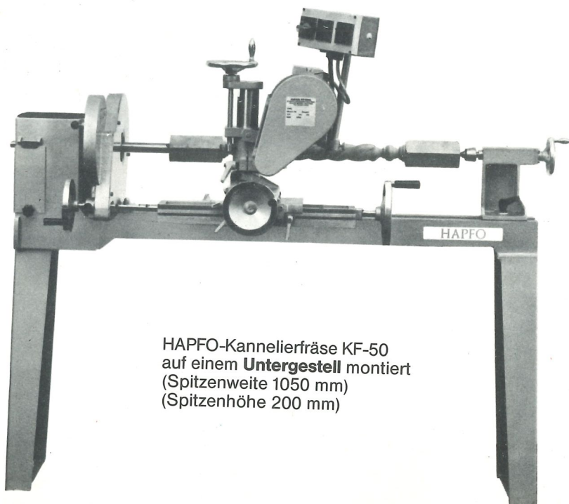
Absaughaube für Kannelierfräse KF-50 komplett laut Abbildung, speziell zum Fräsen von Wundprofilen, Ornamenten, Schlitzarbeiten, Längskanneluren etc. Anschluß: \text{Ø } 120 \text{ mm}
