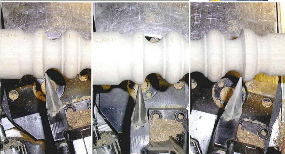
Unsere Maschinen kombinieren bewährte Lösungen aus über 35 Jahren Drehbankbau, mit neuer innovativer Technik, wie z.B. dem schwenkbaren Drehmeißel. Dieser ermöglicht Konturhinterschnitte in beiden Richtungen, in einem kontinuierlichen Bearbeitungsschritt ohne Werkzeugwechsel.
