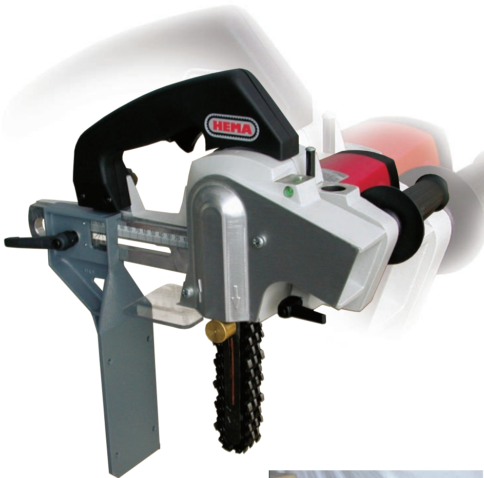
Führungsgestell zum Stemmen, Stemmtiefe 90 mm, inkl. Anschlag. Maschinengewicht durch Gasfeder ausgeglichen.
